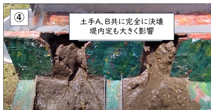
図5-9 堤防の決壊実験結果
